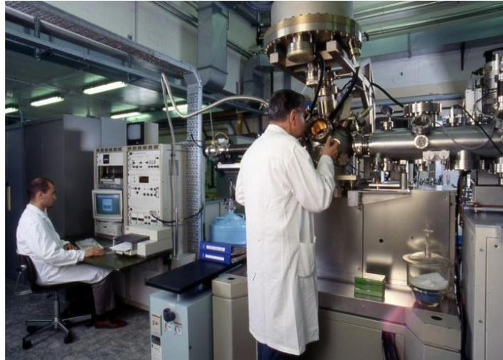
Impianto per la deposizione ionica assistita di materiali in condizioni UHV e di analisi in situ mediante tecnica XPS (CISE anni '90)
