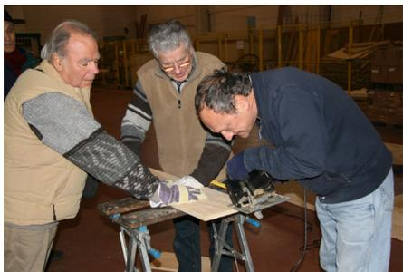
All'inizio, per la creazione della struttura portante di ARETHA, il lavoro è stato essenzialmente di falegnameria: colla, viti, sega. In questa fase si è operato anche in collaborazione con i tecnici Henkel che hanno fornito prodotti per l'incollaggio e sono venuti ad illustrare le tecniche da adottare. L'utilizzo di collanti adeguati in sostituzione di viti o altro è stato utile per rendere più semplice l'assem-
